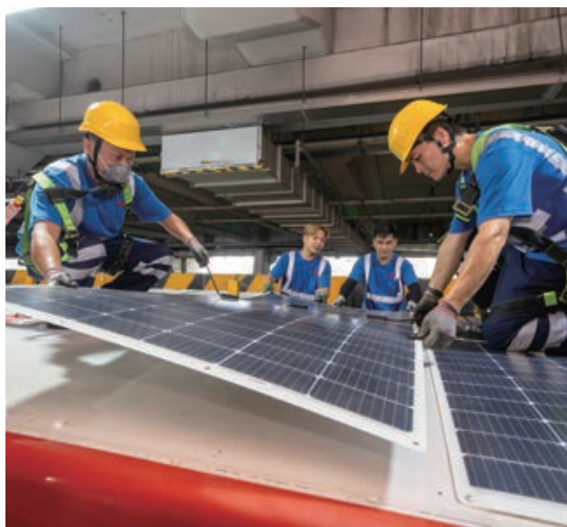
▲ 九巴自行研發於雙層巴士車頂加裝太陽能薄膜，善用可再生資源，減低碳排放
