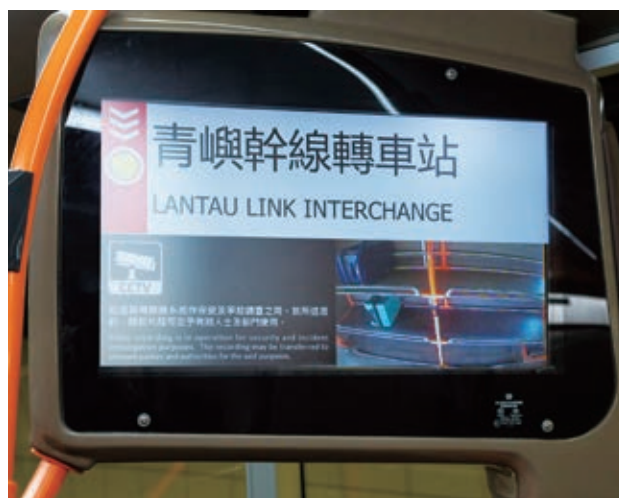
▲ 龍運的巴士設有閉路電視系統，實時顯示行李架情況，讓乘客安坐座位亦能看管自己的行李，安心享受舒適旅程
