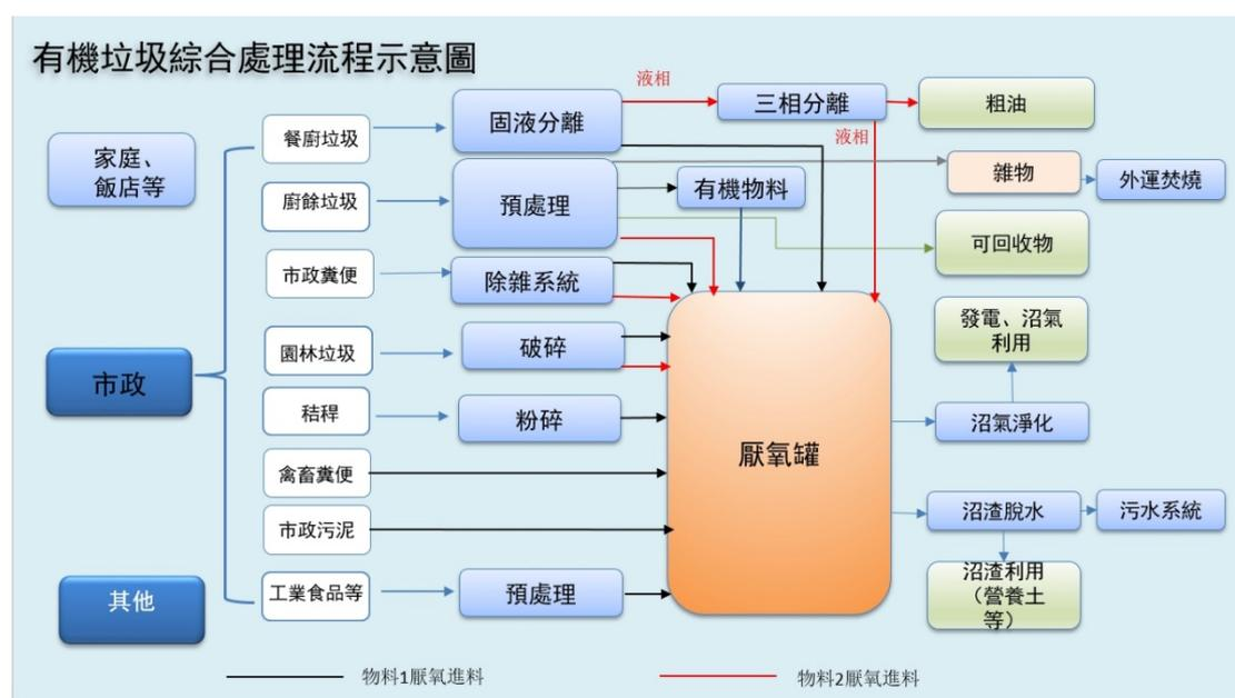
本公司間接控股 92.29% 的子公司藍德環保主要依託高效厭氧反應工藝、MBR 膜生物反應器及其衍生工藝等，對有機垃圾進行系統性綜合處理。2024 年，藍德環保旗下滁州項目獲批自 2024 年 6 月 27 日起轉為試運營項目，北海項目獲批自 2024 年 9 月 30 日起正式轉為商業運營項目。截至本公告日，藍德環保擁有有機垃圾處理項目共 19 個，餐廚垃圾設計處理量超過 4,600 噸/日，其中已有 14 個項目（設計總規模 3,126.5 噸/日）進入商業運營，5 個項目處試運營階段。2023 年以來，本集團對藍德環保業務結構進行了調整，明確了以運營業務為主的經營策略，逐步收縮、終止虧損嚴重的 EPC 工程及裝備製造業務。報告期內，藍德環保運營收入有一定增長，但受油脂銷售價格低迷、提油
