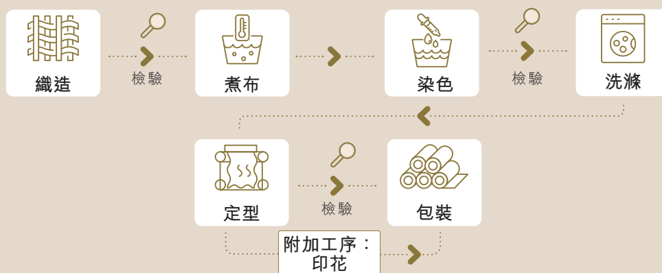
S.Power 廠房的布料生產流程
