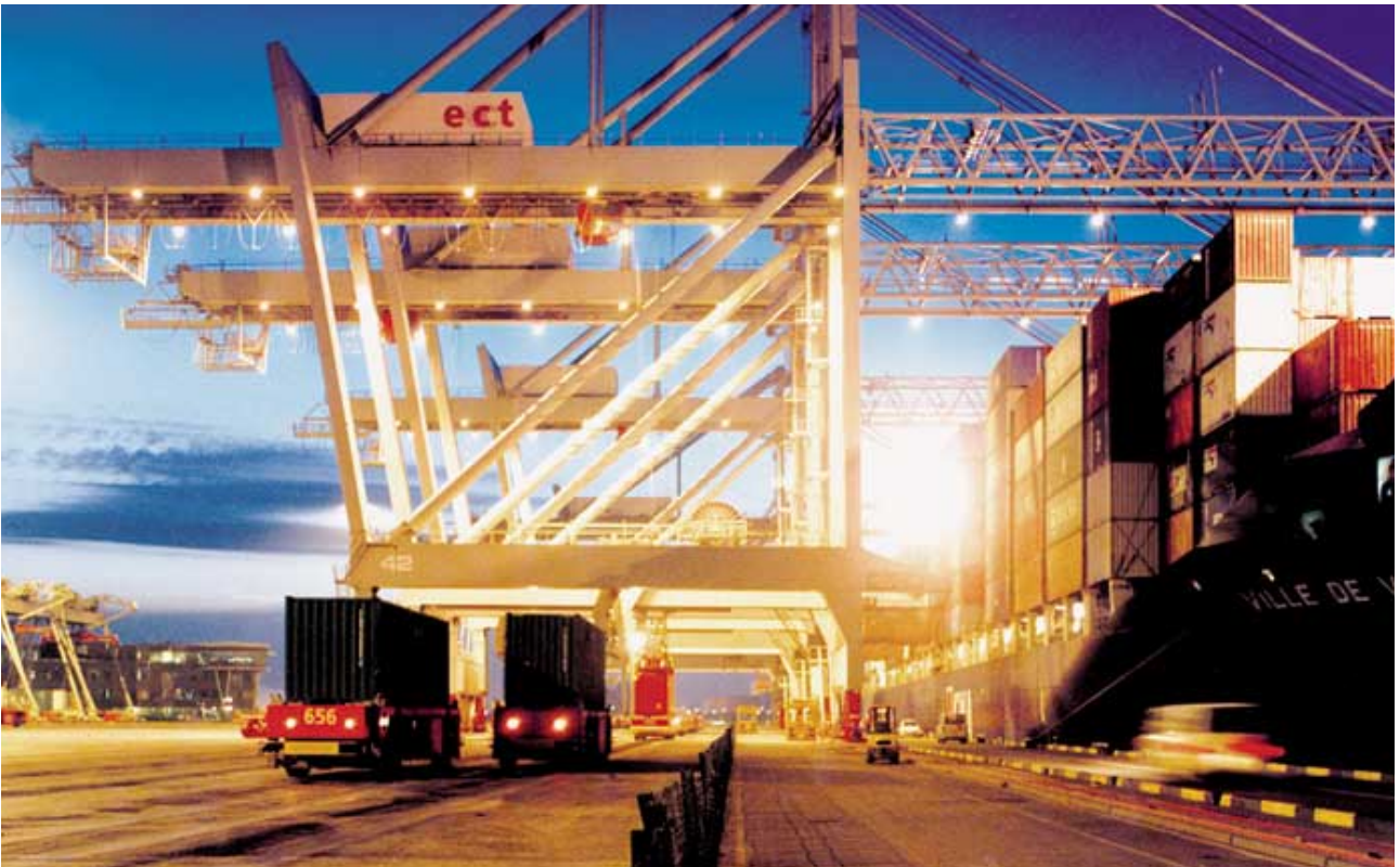
歐洲貨櫃碼頭操作高度自動化，使用自動導行車輛從貨船卸下貨物。
