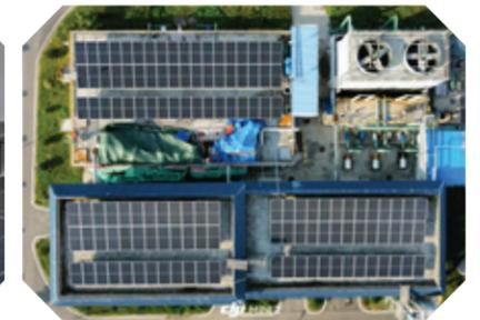
溫嶺固廢處置項目利用廠區內的廠房屋面、事故水池及初期雨水池等位置建設光伏項目，安裝面積約12,000平方米，總安裝容量約為1.6兆瓦。
