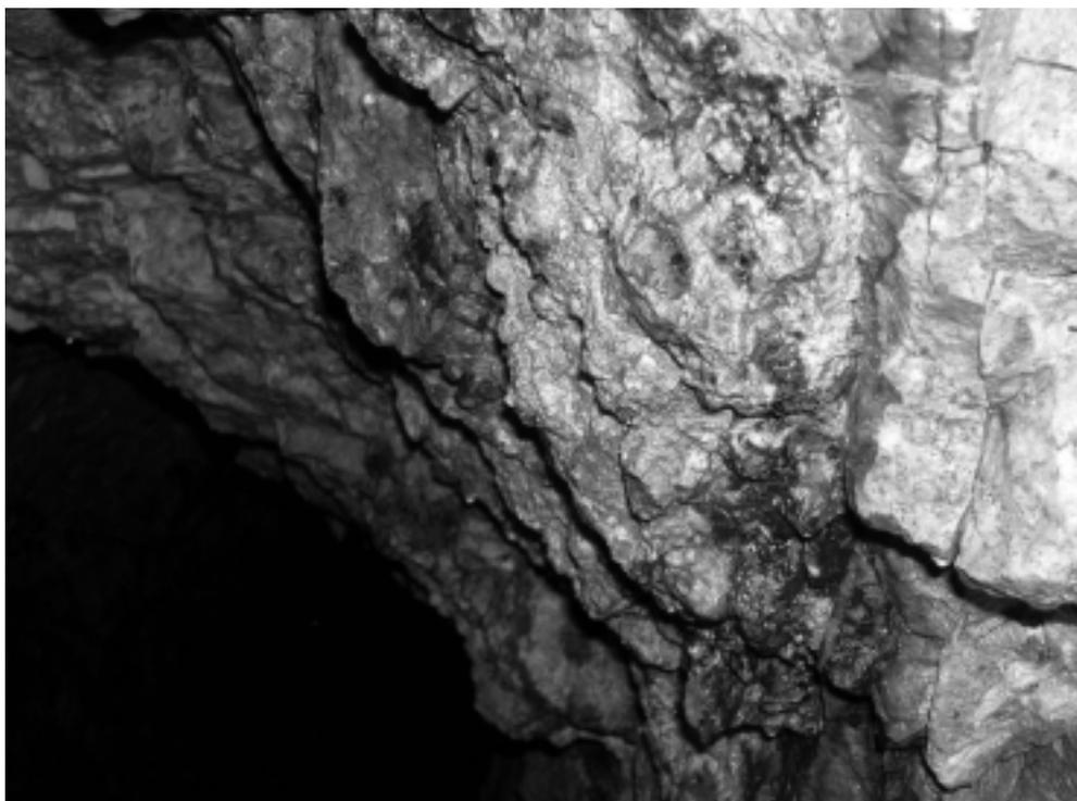
圖4-7：於鐵骨坪遠景區為勘探T-(8)號礦脈而開拓的平硐
