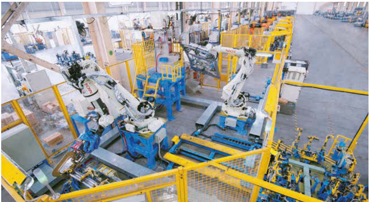
位於重慶之全自動機械臂焊接生產綫
