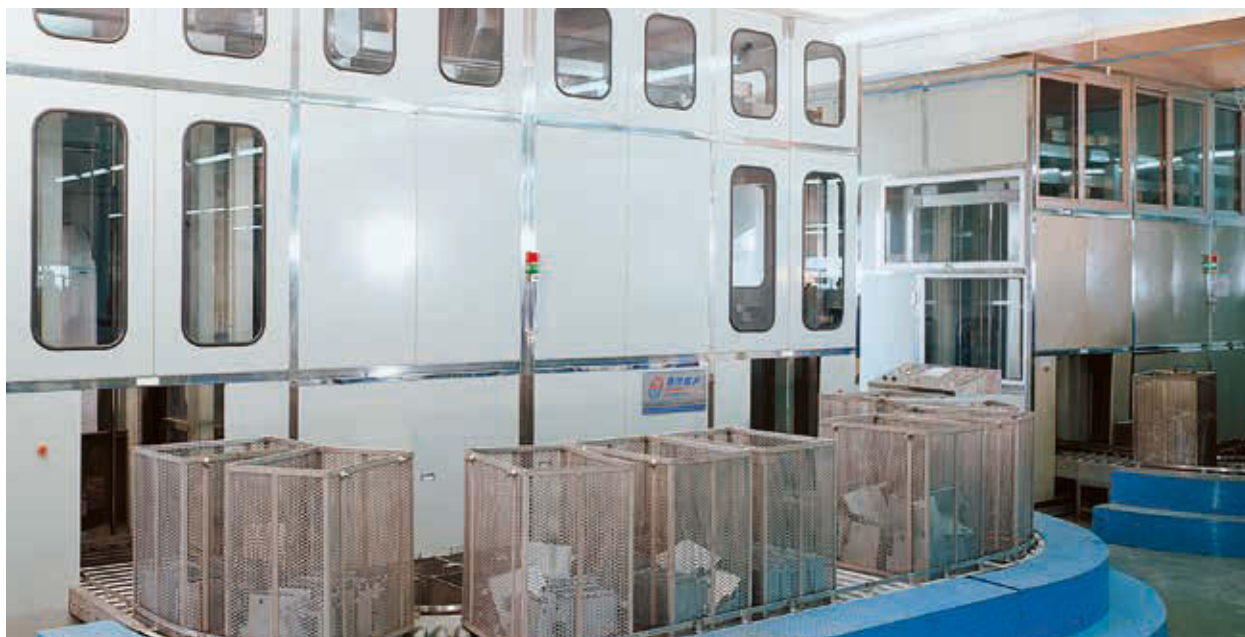
我們利用超聲波清洗機來清洗金屬產品，以取代使用腐蝕性液體的傳統方式
