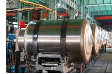
on-vehicle LNG cylinder
