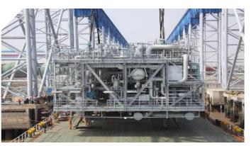
• LNG再气化模块全球市占率领先,为液化天然气 浮式存储 (FSRU) 中的核心设备
