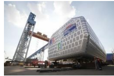
ABC型LNG液货舱、燃料罐
