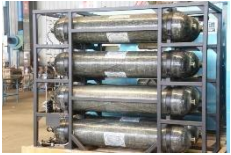
III型车载储氢瓶及供氢系统
