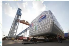
ABC型 LNG液货舱、燃料罐
