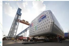
ABC型 LNG液货舱、燃料罐
