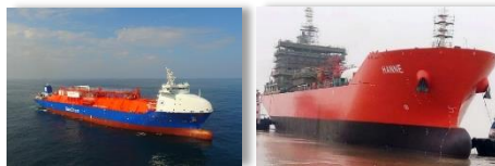
▲ 中小型气体能源运输船 (LEG/LPG/LNG)
