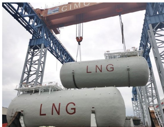
LNG Fuel Tanks
