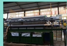
年內南通罐箱改進了酸洗污泥壓濾系統，採用高壓板框壓濾機，過濾面積是原壓濾機的兩倍，共並具備隔膜二次壓榨、自動拉板卸泥、自動翻板（壓濾過程中接水）等功能。污泥含水量因而大幅降低至低於50%，全年污泥減少約360噸，減低了有害廢棄物的產生量。
