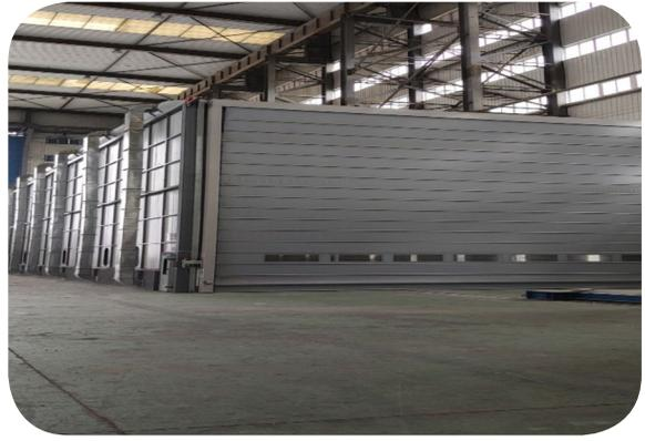
我們為噴漆工序另設密封的操作室，收集並以過濾、活性炭吸附和催化燃燒等技術處理。噴漆工序所排放的 VOCs 大幅降低。
