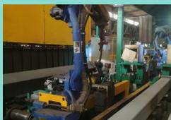
中集安瑞科成員企業南通罐箱研發並應用機械人全自動焊接工作站，焊接工序由機械人工作站自動完成，原工位員工只負責裝配及輸送箱體。除了徹底解決員工高強度焊接作業模式，各生產配件之間的焊縫一次成形，減少中間焊接接頭，有效保證了焊接品質，提高生產效率達 40% 以上，每年改善效率收益達 8 萬元以上。
