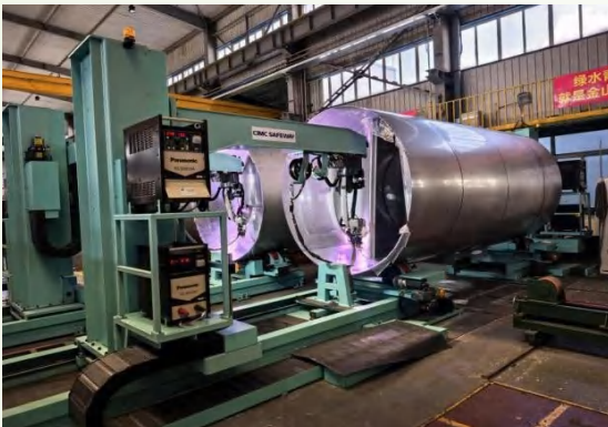
防波板机器人自动焊接现场
