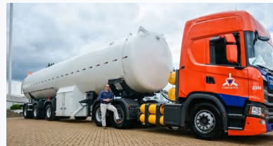
61.7m 3 Ultra-large LNG Semi-trailer
