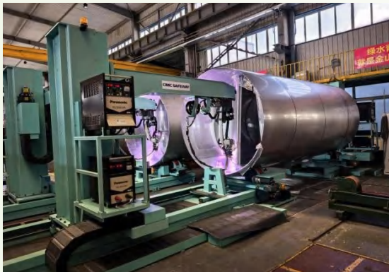
防波板機器人自動焊接現場
