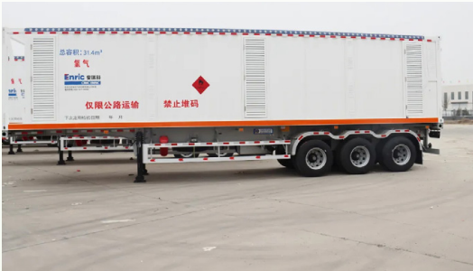
30MPa 碳纤维缠绕氢气管束式集装箱
