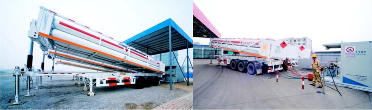
本集團另一新開發產品為液化壓縮天然氣（「LCNG」）加氣站系統，以LNG形式運送天然氣及使用LNG作為給料，把天然氣以壓縮或液化形式為汽車加氣。年內已出售一套LCNG系統。由於LNG的密度較CNG高2.5倍，相比壓縮形式，以液化形式進行天然氣長途運輸更為經濟，因此本集團相信LCNG加氣站系統將成為市場上獨特並極具競爭力的產品。
