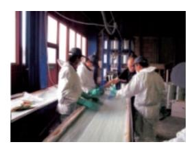
葉片廠在生產過程中採用先進的真空輔助導入技術,它避免了複合材料繁瑣成型和在固化過程中的吸水、分層、含膠量不均等的缺點,反而,該工藝操作簡單,生產環境清潔,產品的穩定性較強,可以實現批量生產、及規模生產。
