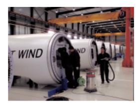
風機總裝廠生產的航天直驅風機,相對傳統 齒輪轉動箱之風機,具備技術優勢包括:高 傳動效率,發電功率可提高5%左右;減少了 設備維護的時間和費用;有利於突破風機零 部件製造的瓶頸,加快風機製造的發展;直 驅風機,特別是永磁直驅風機啟動力矩大是 大型風機的發展方向。
