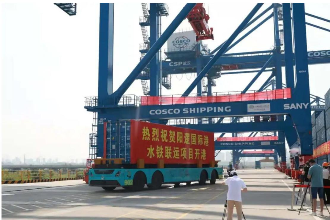
这里，不止是水铁联运。在这里，“智慧港口”技术正与长江第一大水铁联运枢纽逐步融合。作为智慧港口建设上的关键一环，开港活动当天执行任务的这台无人驾驶集装箱卡车（无人集卡“DCV”）由中远海运港口与东风商用车、中国移动基于 5G 和北斗高精定位技术合作开发。港口无人集卡系统集成了调度系统等五大模块，这些模块构成了港口水平运输自动化系统。其中，无人集卡实现定位精度 $\leq 5\text{cm}$ ，一次定位准确率 $\geq 90\%$ ，无人集卡车队投入运营后可实现与有人集卡混合作业。
