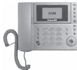
本集團的2.5G無線終端機可支援雙向語音及數據通信。本集團的固定無線終端機的功能與傳統固網電話相若。然而，固定無線終端機並非接駁固網，而是利用移動電信網絡傳送語音和資料。終端設備只需配合插入式SIM卡，便可接駁移動網絡。本集團部分的固定無線終端機可接收文字及／或圖像信息，如金融市場信息、股票報價、新聞及電郵。本集團的固定無線終端機可兼容 CDMA 或 GSM/GPRS 網絡。此外，本集團部分
