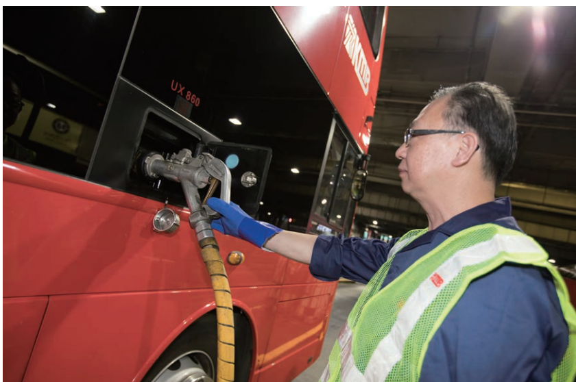
九巴及龍運巴士採用飛機使用的「Posilock」加油系統，防止燃油外溢
