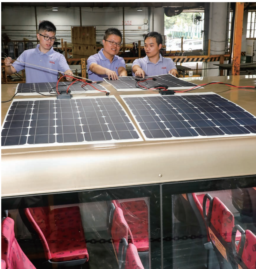
九巴專業的工程團隊引入第一部自行研發配備太陽能發電裝置的雙層巴士
