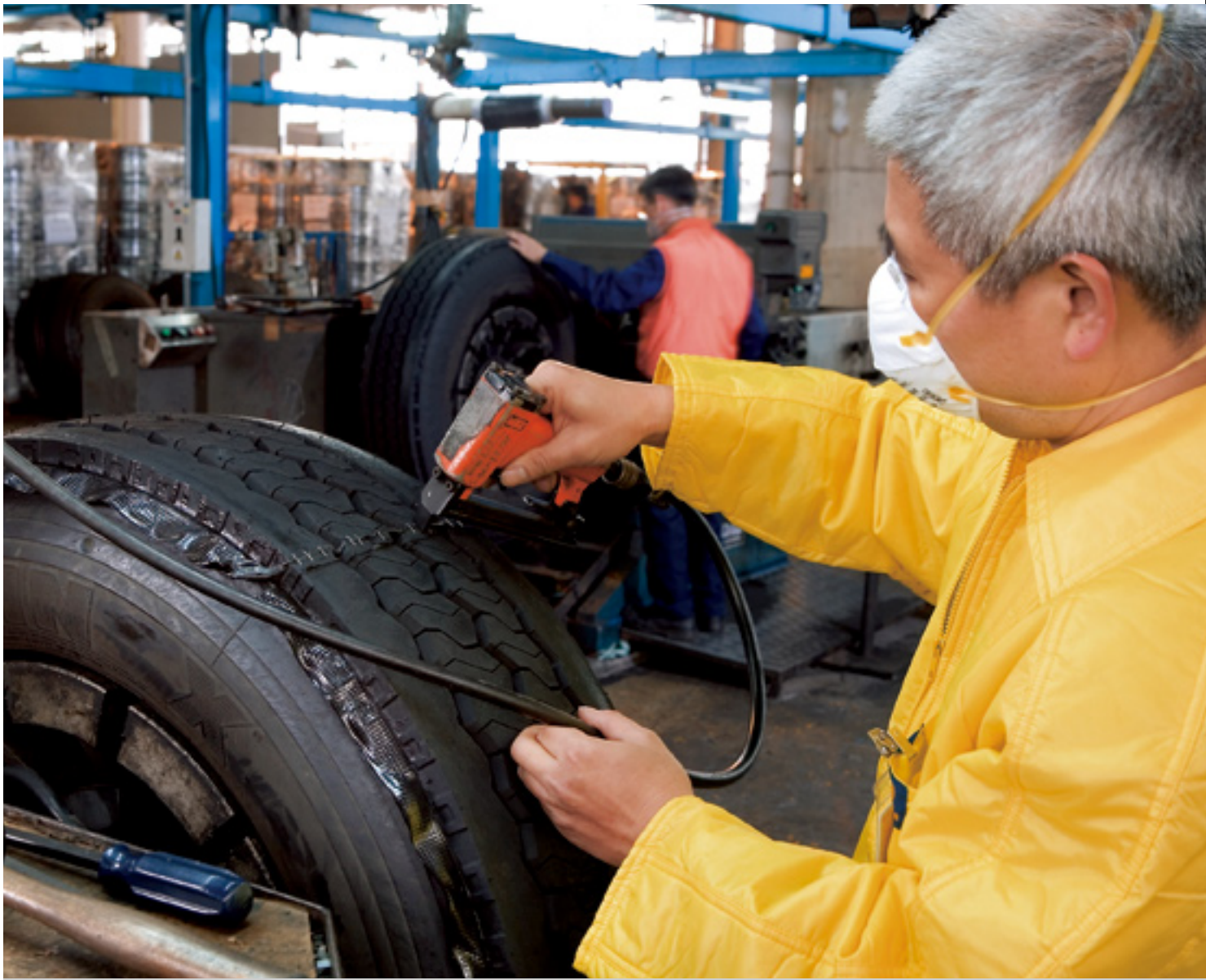
屯門車廠的輪胎翻新設施
