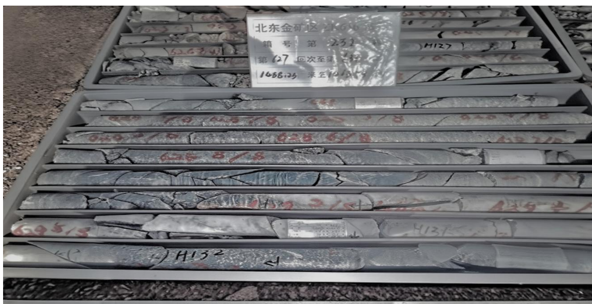
附图 2-1 ZK616 发现的第四层含金矿脉特征（深色岩心为适应绢云母片岩，浅灰色部分为花岗闪长岩，乳白色部分为含金石英脉，与现阶段已控制的矿脉特征一致。）
